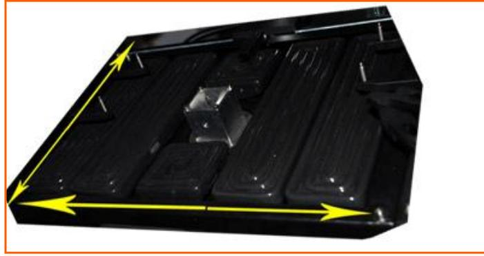
4、上部风嘴设计，更好的保护芯片核心。网孔直径是从中间到四周逐步变大，从而使热量更均匀的散布在 BGA 芯片上。
